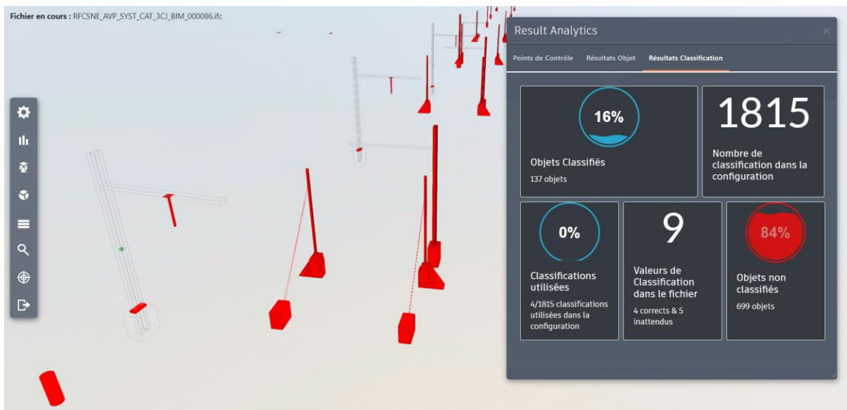
Fig.32 : Model Checking eLODy, Étude caténaire SYSTRA, vérification spécifique d'une classification appliquée
