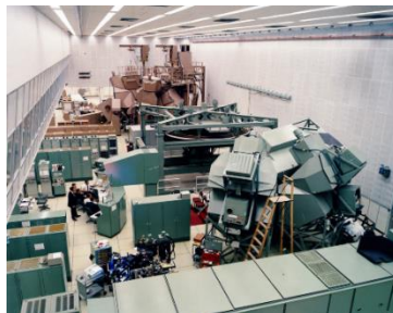
Figure 3 Un jumeau physique au sol d'un satellite dans l'espace piloté par les données transmises depuis le satellite. NASA
